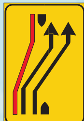
FIG. 413/c ART. 43 SEGNALE DI RIENTRO IN CARREGGIATA
